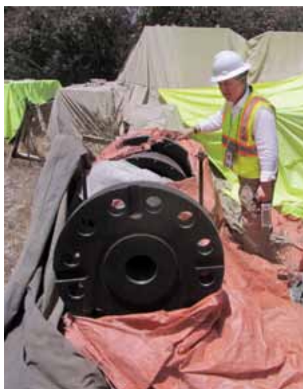
پرز جات توربین سوم در فابریکه بند برق کجکی سال ها در انتظار نصب در زیر تریال ها در خارج از سالون رها شده اند. (عکس SIGAR)
